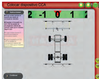
Alineación del travesaño de medición
