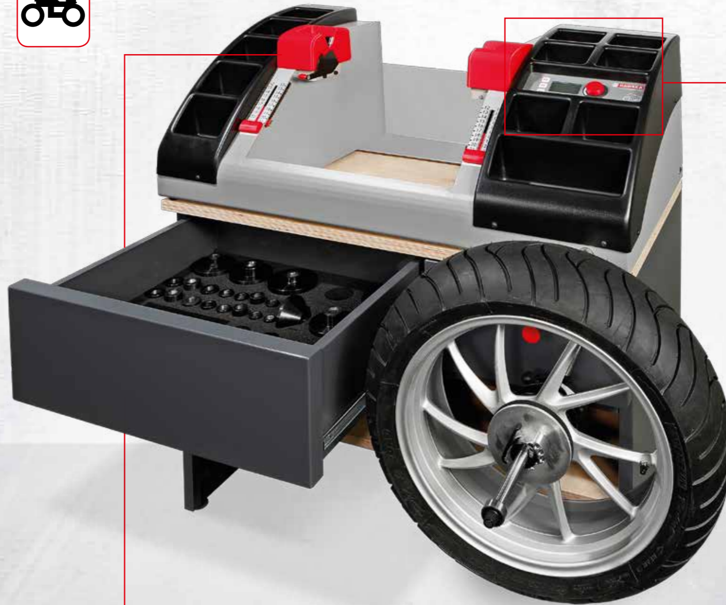
Das übersichtliche Display dient zur Eingabe der Rad- daten und zeigt an, wo am Rad die Auswuchtgewichte anzubringen sind.
