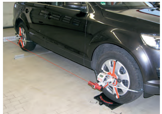
Beispiel einer Vorderachsmessung.
