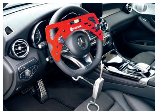
Anbringung der Lenkradeinstellwaage und des Lenkradfeststellers.
