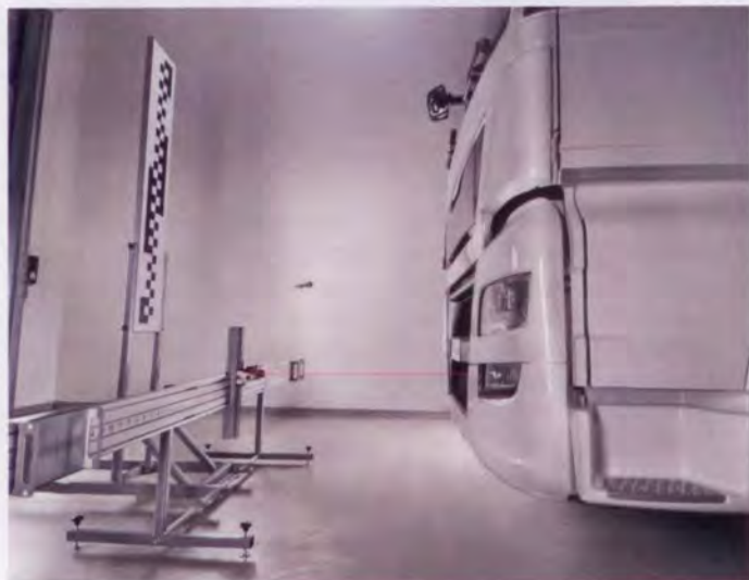
▲ Per Laserpunkt eines Laserschlittens lässt sich der Sensor in der Höhe ausrichten – hier am System von Texa/Haweka zu sehen.
