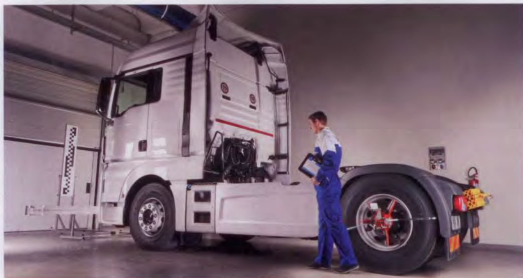
▲ Zur Justage der Sensorik ist es auch nötig, die exakte Ausrichtung der Fahrzeugachsen zu erfassen.
