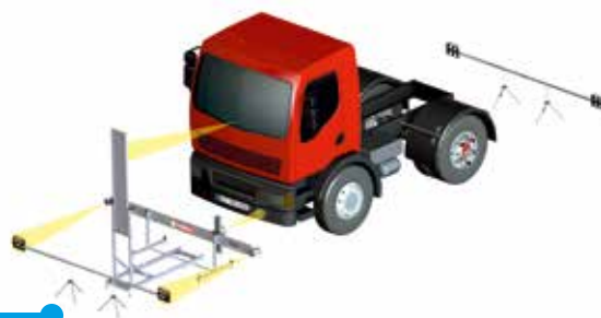
La traversa di misurazione e il riflettore di calibrazione sono allineati orizzontalmente ad una distanza esatta davanti al veicolo.
