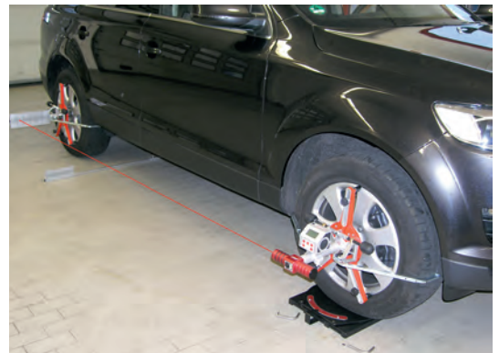
Ejemplo: Medición del eje delantero
