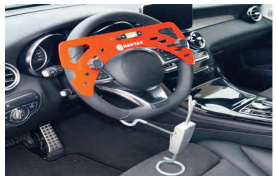
Se controla la posición central correcta del volante de dirección.
