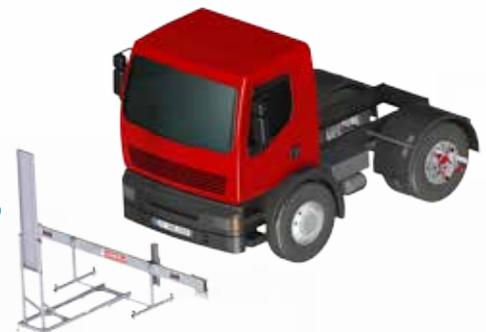
Die Mess-Traverse und der Kalibrierreflektor stehen waagrecht ausgerichtet in einem exakten Abstand vor dem Fahrzeug.
