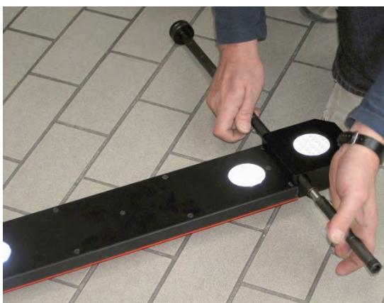
Einhängestangen durch die Skala führen und wieder zusammenschrauben.
