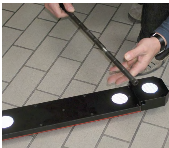
Die Einhängestangen am Ende auseinander schrauben.
