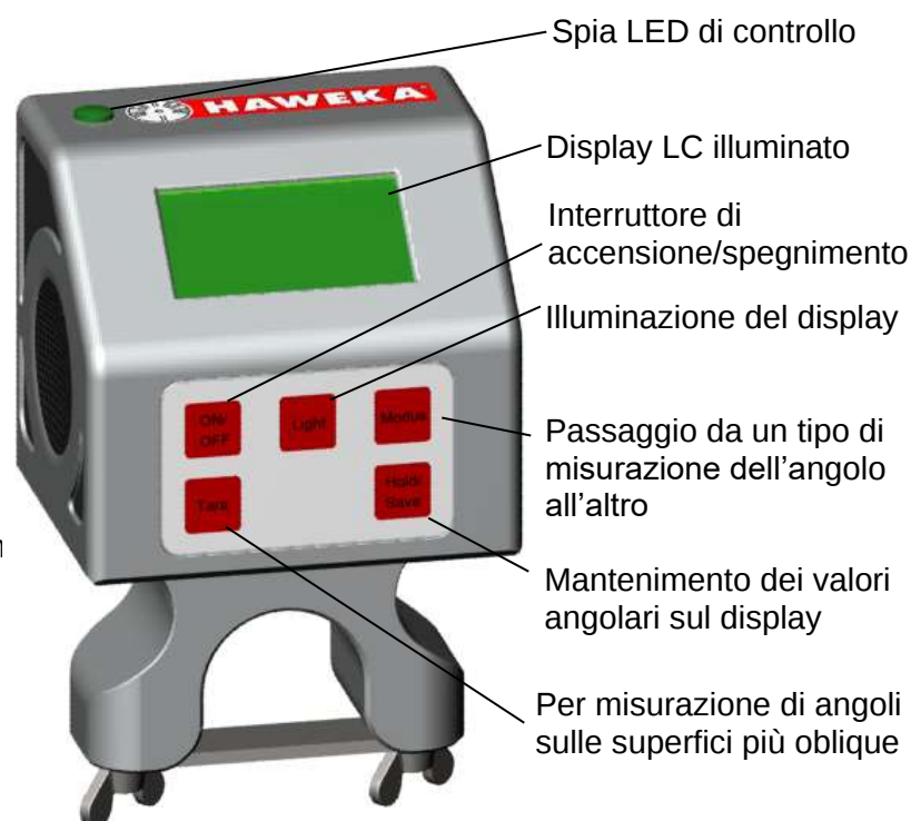
Richiesta di rilevamento valore Incidenza montante / inclinazione montante
