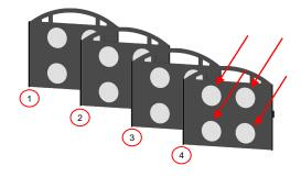
Die Reflektortafeln dürfen in den jeweiligen 4 Kreisen keine Beschädigungen oder Fehler in der Folie aufweisen.
