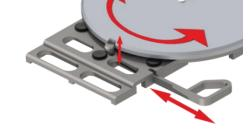
Es ist zu überprüfen, ob sich über die Schieber die Drehscheibe verriegeln lässt. Die Drehscheibe muss bei entriegelter Stellung seitlich verschiebbar und drehbar sein.
