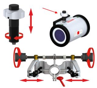
Die Spindel vom Spannkopf muss sich leicht in beiden Richtungen verdrehen lassen, und die Schwenkarme dürfen dabei nicht verkanten und werden durch die Federkraft mittig in gleicher Position gehalten.
